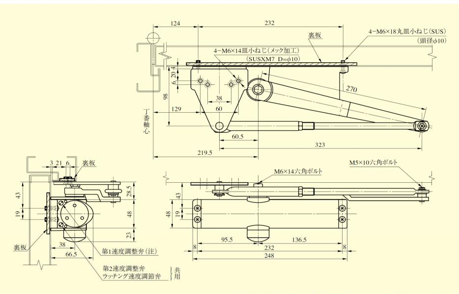
(注) KM314PDA型の場合のディレードアクション調整弁は第一速度調整弁と共用です。 ・ブラケットはKB-2型が標準です。(KM314PDA型の場合も同一となります。)
