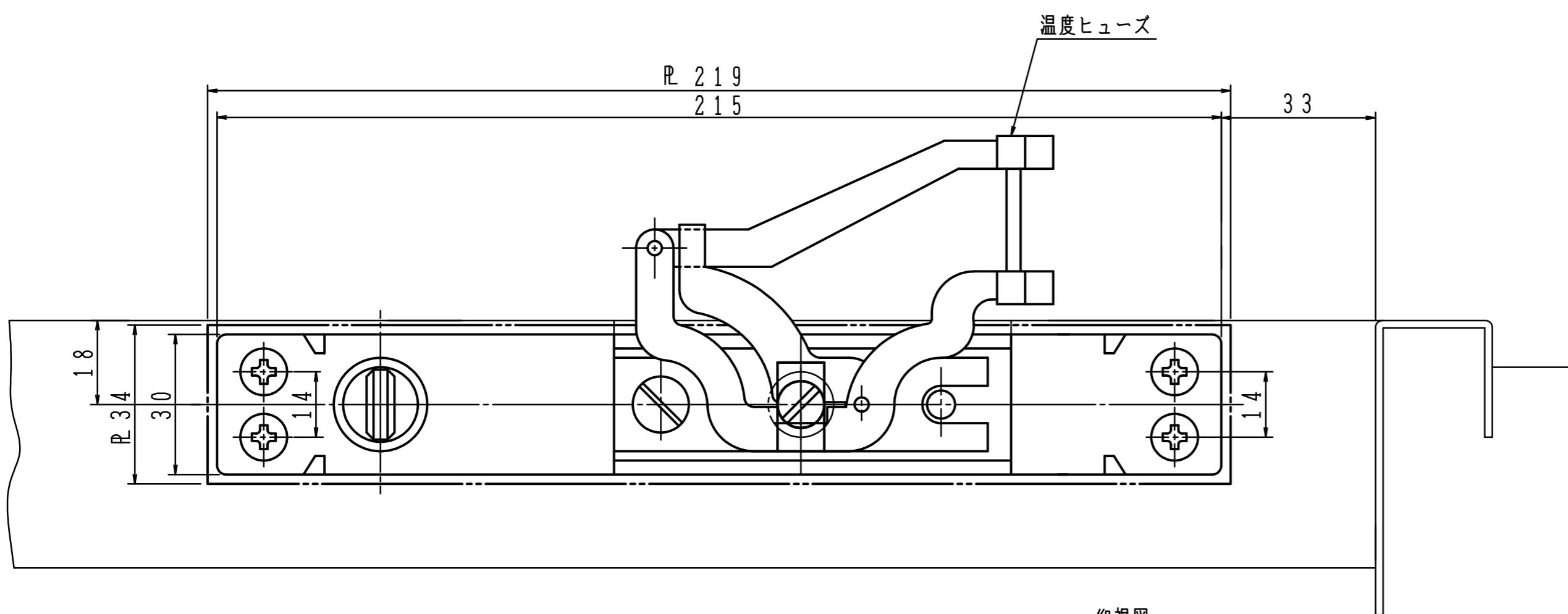
ドアと戸袋壁面の隙間に遊びがある場合は、戸当り(別途)を設置して遊びを無くして下さい。
