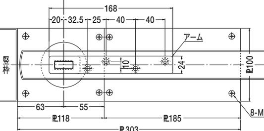
一方開き用ヒンジには押し代がついています。ドアを閉めた時に、反対側へ5°行過ぎて停止しますので、必ず戸当り(別途)を設置して下さい。
