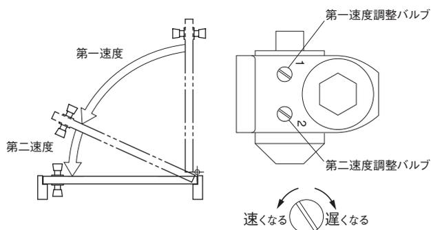
調整が必要な場合は、第一速度は“1”のマーク側のバルブ、第二速度は“2”のマーク側のバルブを回して調整して下さい。
