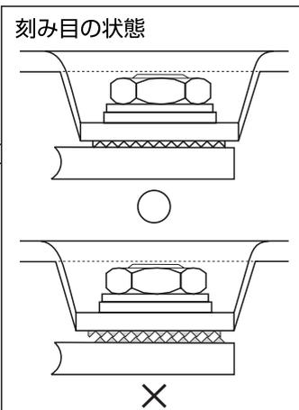
ストップ用ボールがストップ用カムにはまった状態で、ストップさせたい位置までドアを開き、締付ナットを締付けます。(出荷時、ストップ用ボールとストップ用カムははまった状態で、ブラケットは回転する程度に設定してあります。ブラケットとストップ金具座の連結部分は絶対に分離しないで下さい。)
